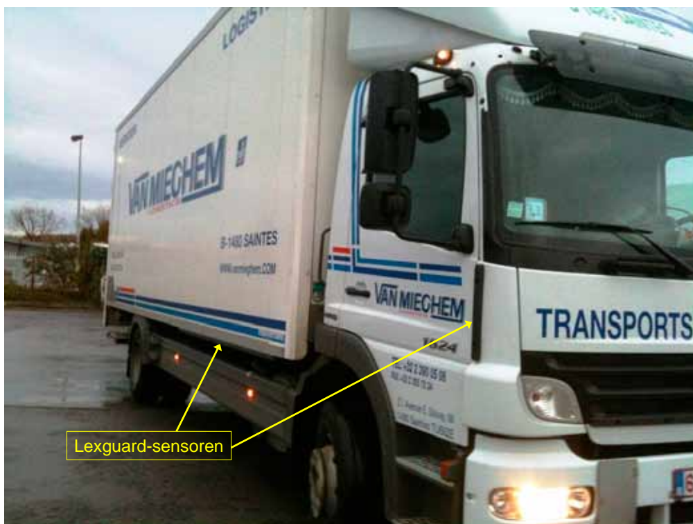
FIGUUR 4 : vrachtwagen uitgerust met Lexguard-sensoren op de rechterkantkant van de cabine en op de zijkant
