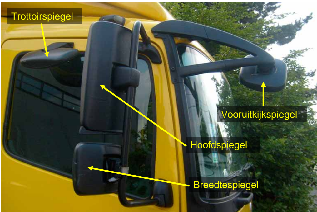
FIGUUR 3 : Opstelling van de spiegels op de rechtersvoorhoek van een vrachtwagen (infografie BIVV)
