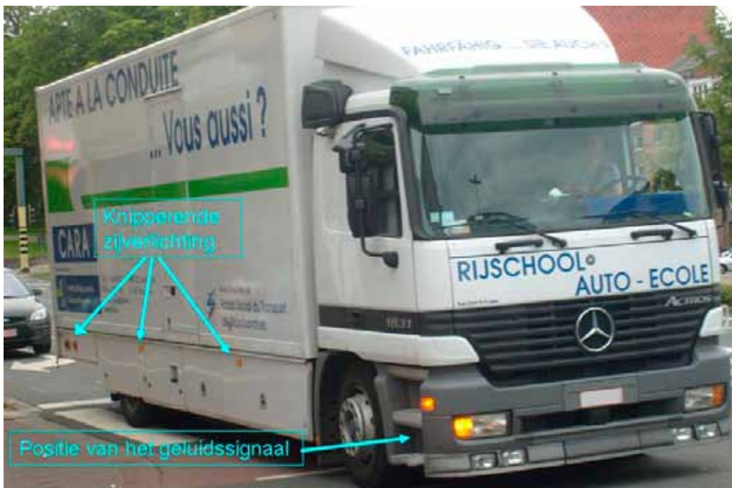
FIGUUR 5 : Positie van het Lisa-2-Alert systeem op de testvrachtwagen
